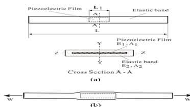
Gambar 1 Struktur sensor
